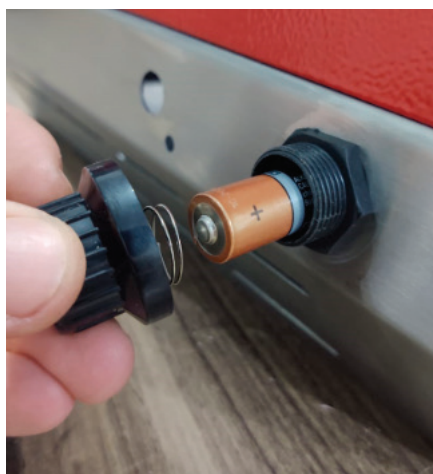
2 - Posicionar a pilha AA com o polo NEGATIVO para a parte interna da usina e POSITIVO para fora. Após posicionado a pilha, colocar a tampa e rosquear novamente fechando a usina.
