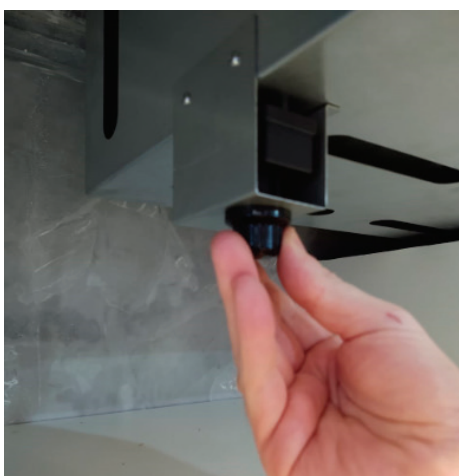
1 – Desrosquear a tampa da usina a pilha;
