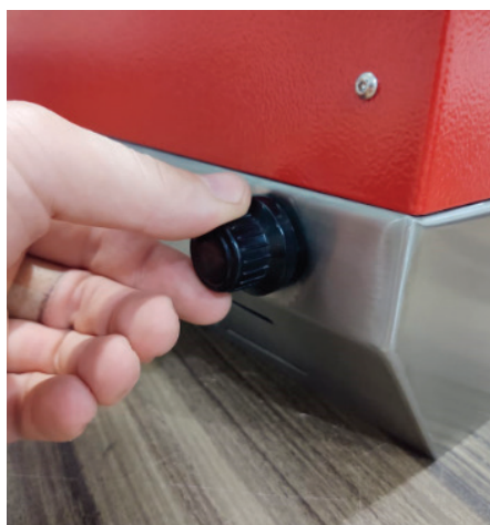
1 - Desrosquear a tampa da usina a pilha;
