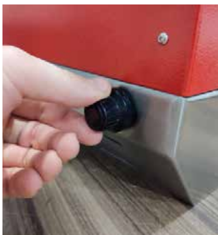
1 – Desrosquear a tampa da usina a pilha;
