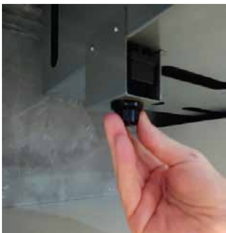
1 – Desrosquear a tampa da usina a pilha;
