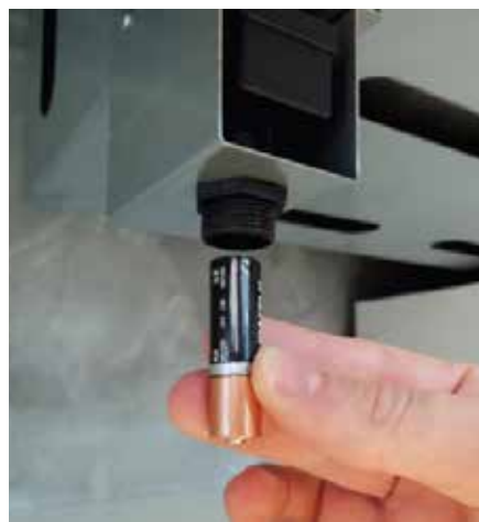
2 - Posicionar a pilha AA com o polo NEGATIVO para cima e POSITIVO para baixo. Após posicionado a pilha, colocar a tampa e rosquear novamente fechando a usina.
