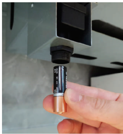
2 - Posicionar a pilha AA com o polo NEGATIVO para cima e POSITIVO para baixo. Após posicionado a pilha, colocar a tampa e rosquear novamente fechando a usina.
