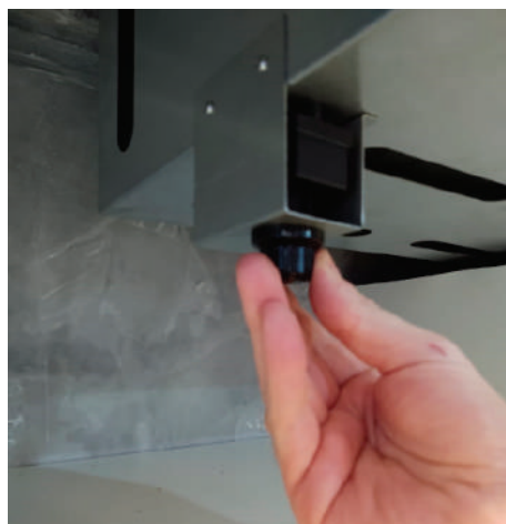
1 – Desrosquear a tampa da usina a pilha;
