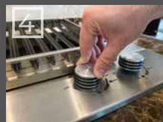
**4º passo:** Aguarde de 5 a 10 segundos com o botão de temperatura ainda pressionado, para ativar a válvula de segurança **SAFE STOP**;
