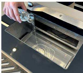
Essa reposição pode ser feita com um recipiente (jarra, copo, caneca, etc.), despejando a água sobre a grelha. Pode-se utilizar também um funil para conduzir a água de forma melhor entre a grelha e a bandeja.
