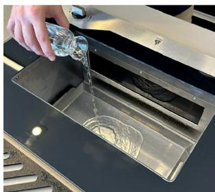
**2º Passo:** Abasteça a bandeja coletora de gordura com água antes de usar o equipamento. É importante ressaltar que é necessário repor a água sempre que necessário para evitar que o acúmulo de gordura produza fumaça durante o uso.
